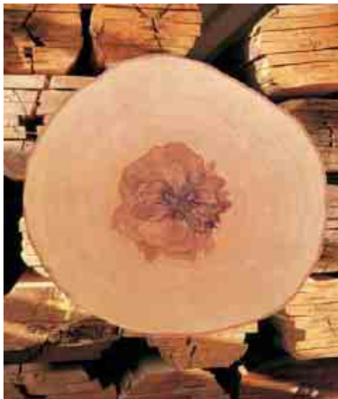
Abbildungen 5.3 und 5.4: Rotkernige Buche in der Verarbeitung
